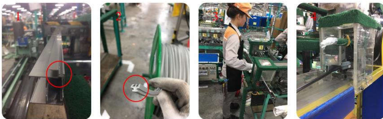
Hình 1. Quy trình đùn dây thủ công (1) Thanh nhôm; (2) Dây cao su; (3) Đùn dây; (4) Cắt dây
